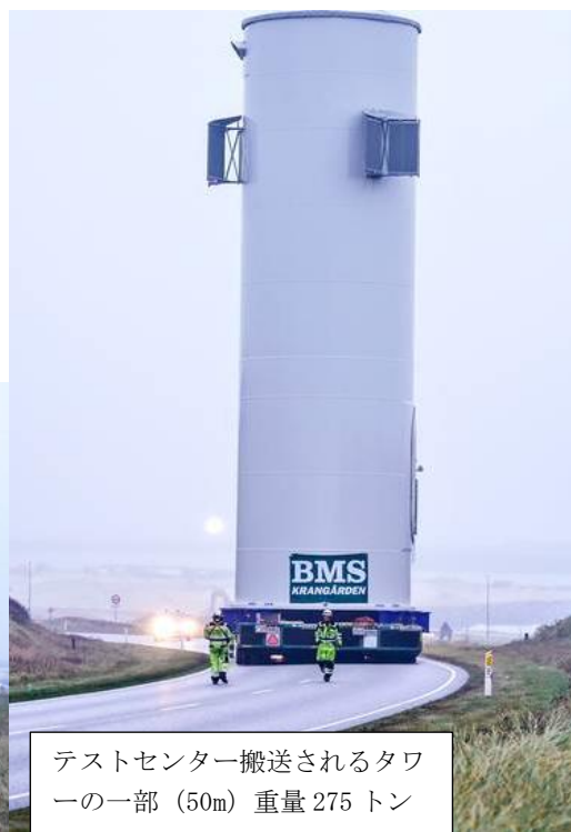
移動車両の長さ 55m。 運搬車の牽引力 2,000 馬力
