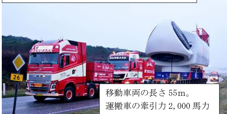
テストセンター搬送されるタワーの一部（50m）重量 275 トン
